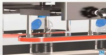
Module de séchage en sortie de tunnel
