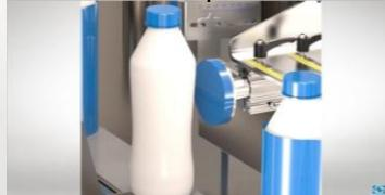
Module de séchage en sortie de tunnel de rétraction
